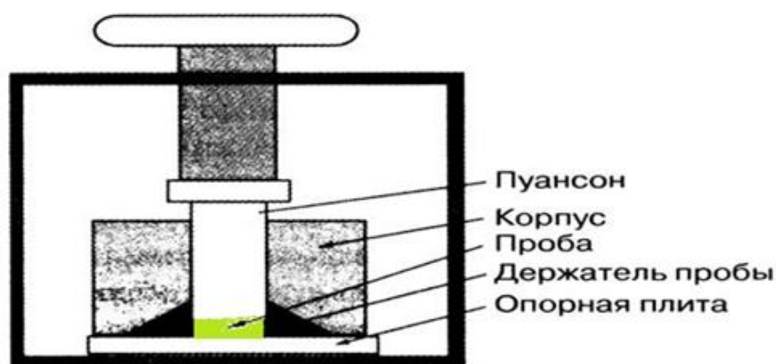
Рис. 2.2. Пресс-форма для прессования образца с \text{KBr} .
