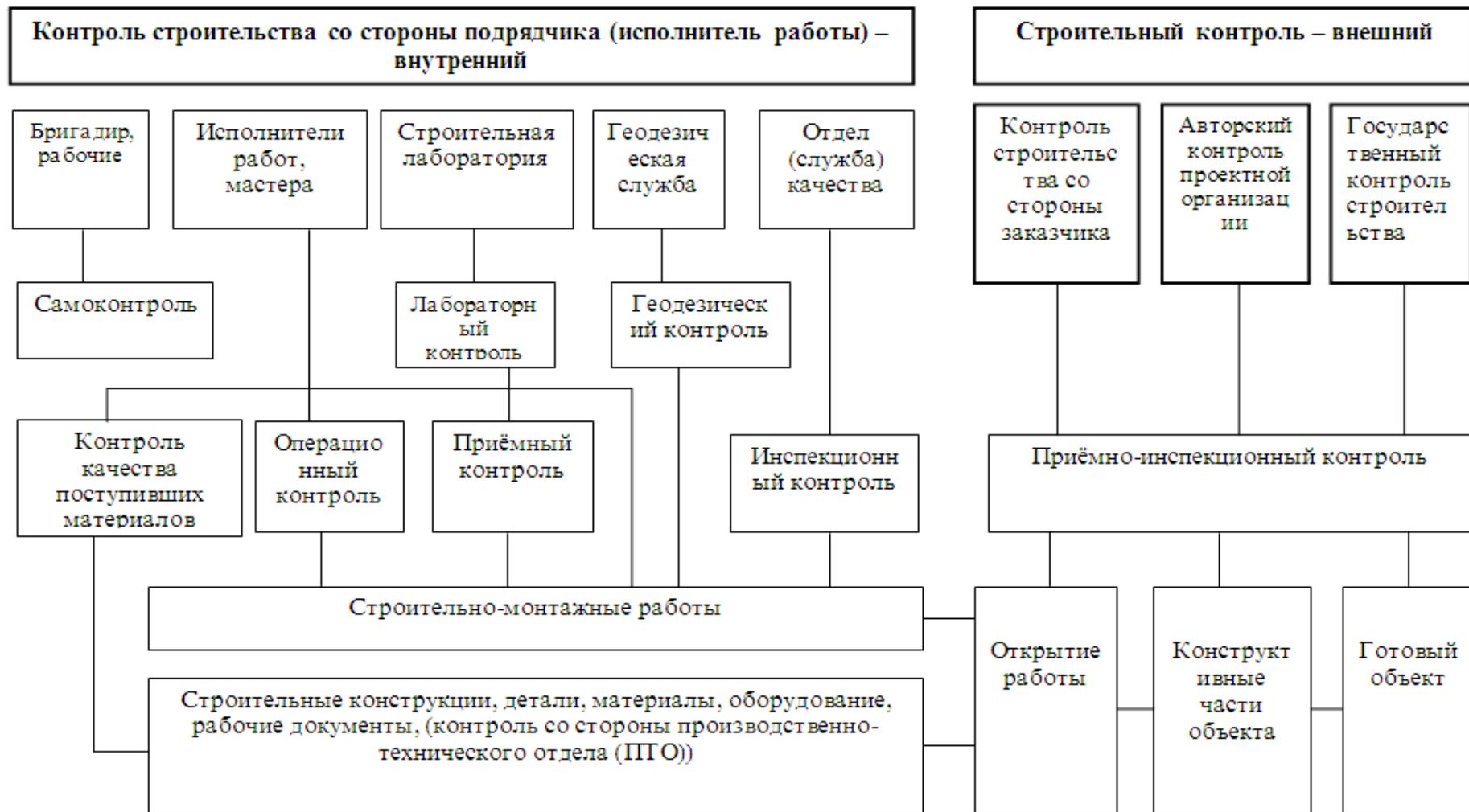
**Рисунок 3. - Схема организации системы контроля в строительстве**
