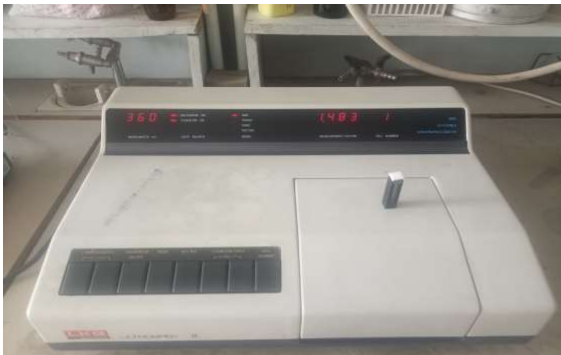
Фото 2.1. Спектрофотометре Ultraspec II (Швеция).
