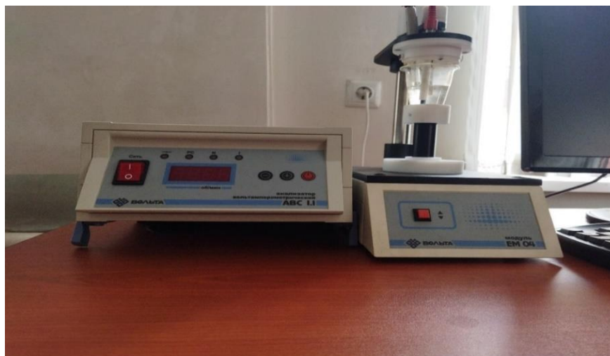
Расми 8. Асбоби волтаметр ABC LI барои муайян кардани MB
