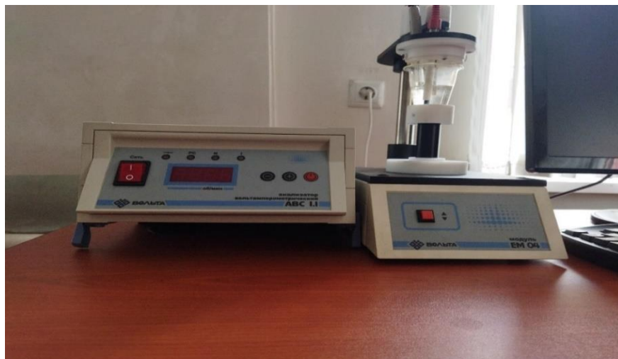
Расми 12. Асбоби волтаметр ABC L.L барои муайян кардани МВ
