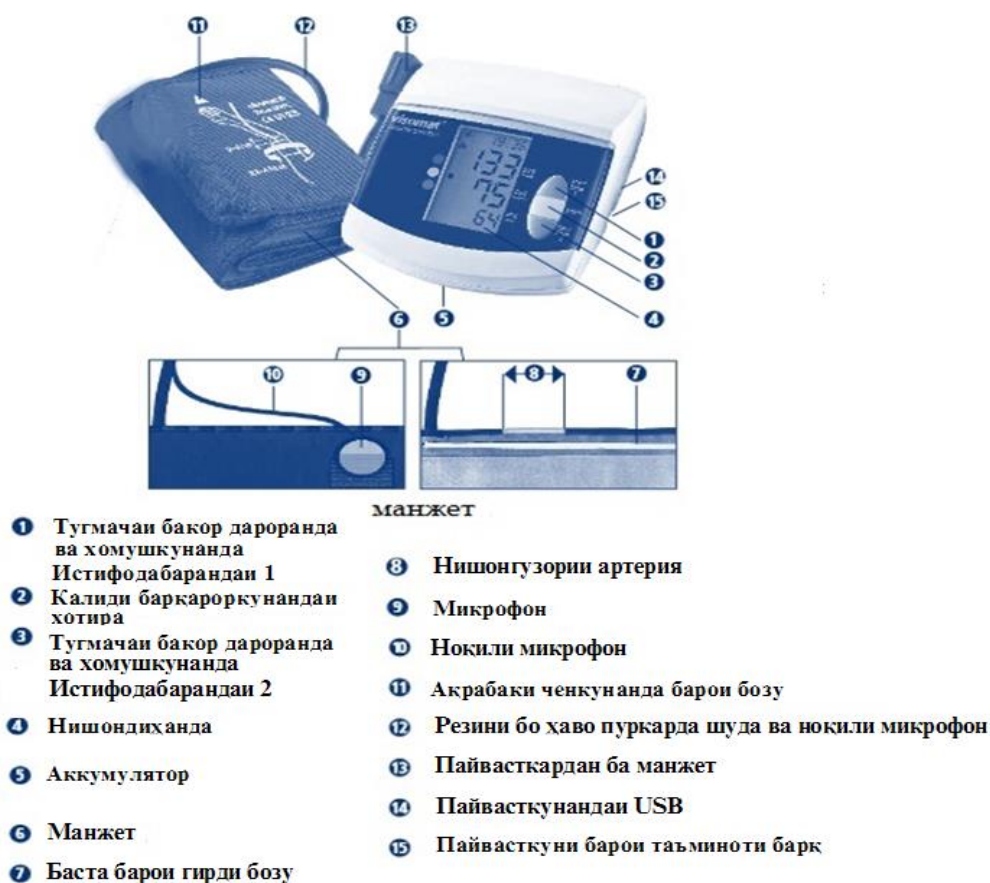
Расми 2.1. - Намуди умумии манометри барқӣ
