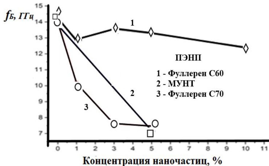
Рис. 3.16. Концентрационная зависимость значений f_B пиков бриллюэновских частот для нанокompозитных плёнок ПЭНП.
