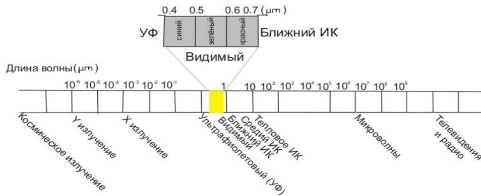
Рисунок 2.1. Диапазоны электромагнитного спектра
