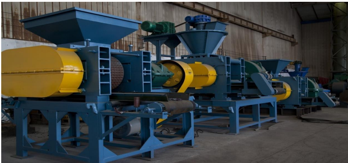
Расми 4.3.3.1. - Шакли таҷҳизот барои истеҳсоли қолаби фишурдаи хокаи ангишт (расм аз сомонаи интернетӣ)
