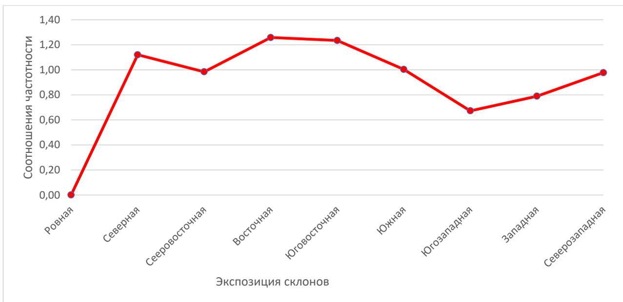
**Рисунок 4.7.** - График зависимости соотношения частотности оползневых явлений от показателей экспозиции склонов [68]
