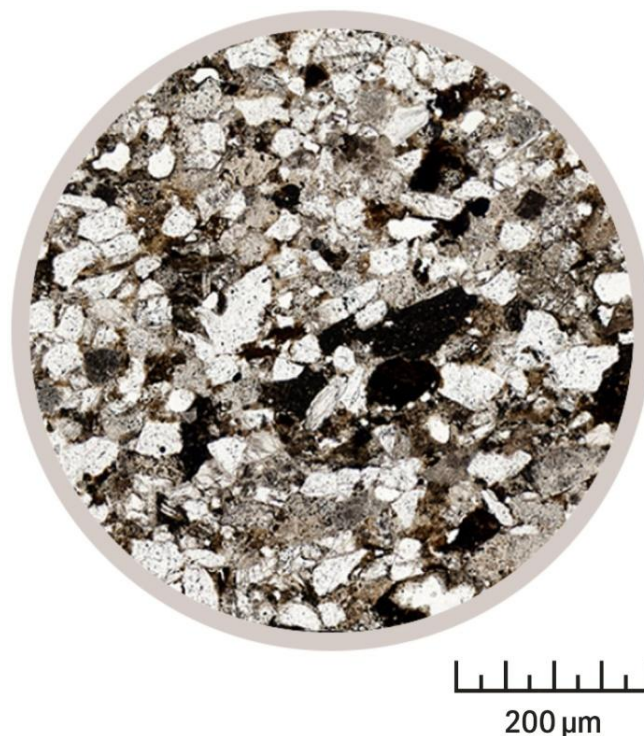
Рисунок 3.2.8. - Микрофотография песчаника. (Порода сложена преимущественно обломками кварца и полевых шпатов с редкими фрагментами темновесных минералов. Межзерновое пространство частично выполнено тонкодисперсным матриксом и цементом, наблюдаются поры неправильной формы. Характерна средняя сортировка обломочного материала). (снимок получен Рахимовым Х.А., сотрудник лаборатории Khalifa University, в 2025 году, петрографическое описание и интерпретация автора)
