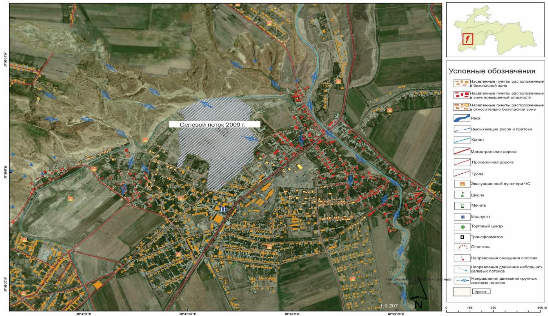
Рисунок 4.1.1.1. - Карта пораженности опасными геологическими процессами населенного пункта Уяли Хуросонского района, с отображением на ней селевого потока 2009 года (Саидов М.С., Шарифзода М.И.)
