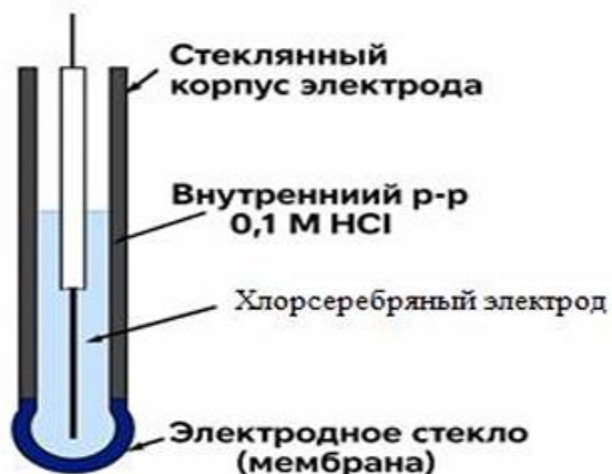
Рисунок 2.1. - Схема комбинированного электрода
