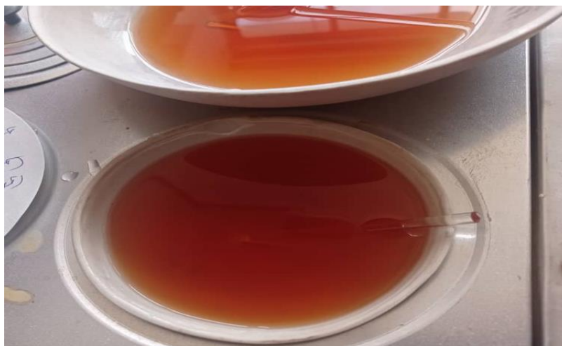
Рисунок 4.1.2. - Раствор гетероядерного комплекса \text{Fe(II)-Fe(III)} и \text{Mn(II)} с ацетат-ионами перед выпариванием.
