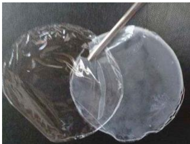
Рис. 3.5.1 Пленки ДПЖК (левая - комбинация П7ЖК3); (правая - П4ЖК6)
