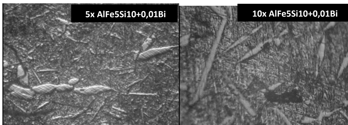
Рис. 5.27. Микроструктура сплава AlFe5Si10 модифицированного с висмутом
