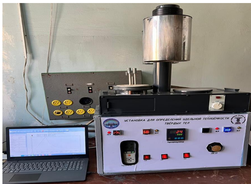
Рис. 2.1. Общий вид экспериментальной установки по измерению удельной теплоёмкости твёрдых тел.
