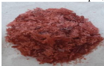
Расми 14. - Кристаллҳои аввалин маротиба синтезшудаи комплекси оҳан(III) ва манган(II) бо атсетат-ионҳо. Дар сфераи дохилии координатсионӣ якбора ду металл ҷой гирифтааст.
