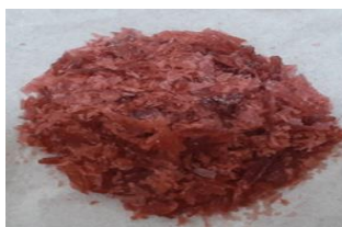
Рисунок 14. - Синтезированные впервые кристаллы комплекса железа(III) и марганца(II) с ацетат-ионами. Во внутренней координационной сфере находятся сразу 2 металла.
