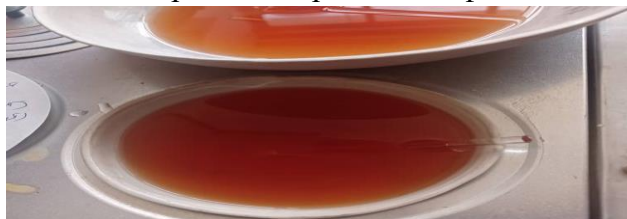
Расми 13. - Пеш аз бухоршавӣ системаи моеъи компонентҳои асосӣ сульфатҳои оҳан(III) ва манган (II), кислотаи атсетат чунин намуд дошт.
