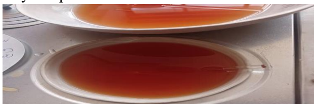
Рисунок 13. - Перед выпариванием жидкая система, основными компонентами которой были сульфаты железа(III) и марганца(II), уксусная кислота, выглядела как на этом снимке.
