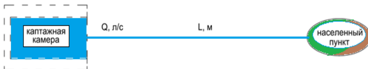
Рисунок 1. Схема подачи воды из одного нисходящего родника в один населенный пункт
