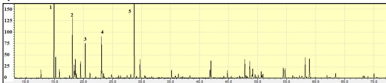
Рисунок 3. Хроматограмма ЭМ Polychrysium tadshikorum . 1. сабинен 2. п-цимол 3. \gamma -терпинен 4. линалоол 5. терпинен-4-ол.
