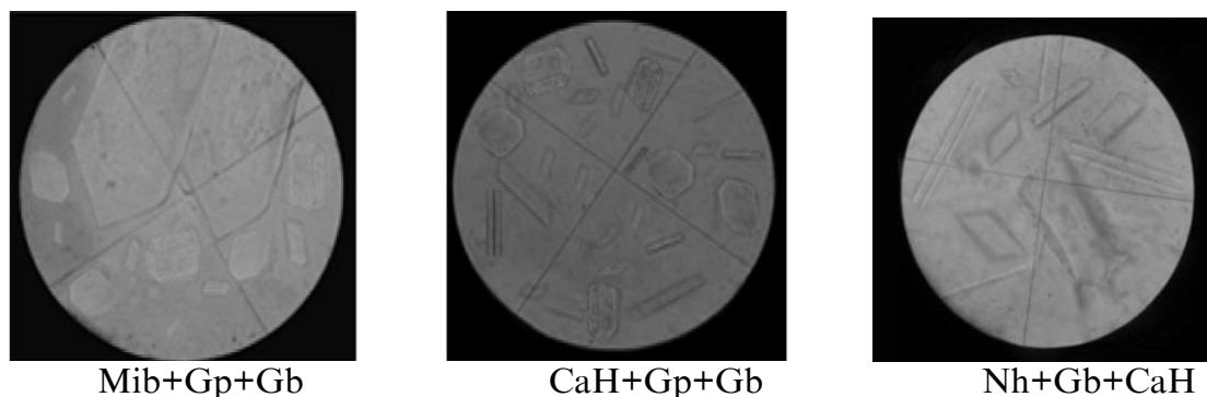
Рисунок 14 – Микрофотографии равновесных твердых фаз системы Ca 2+ , Na + || SO 4 2- , HCO 3 - - H 2 O при температуре 298 К
