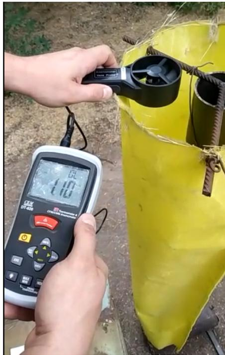
Рисунок 3 – Замер скорости восходящих из щелевого зазора потоков нагретого воздуха в экспериментальной установке
