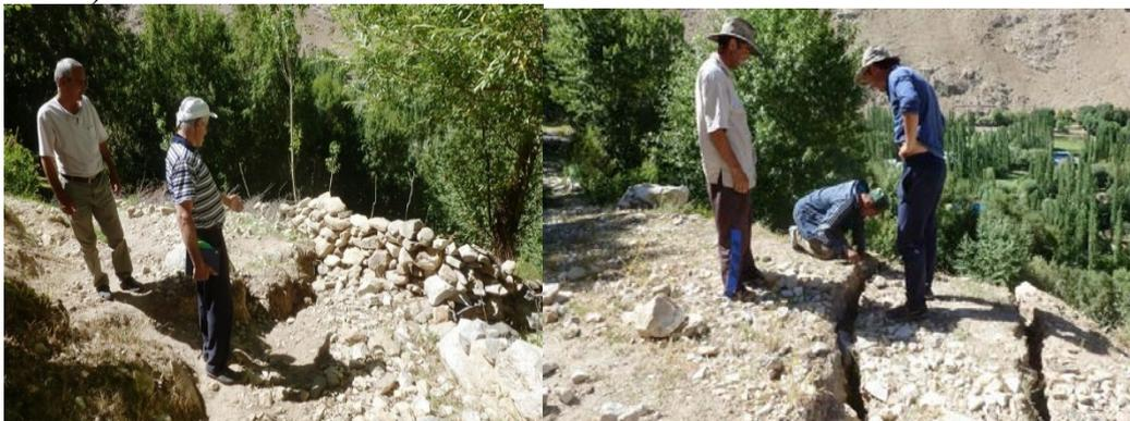
Рис. 7. Трещины отрыва на оползневом теле
