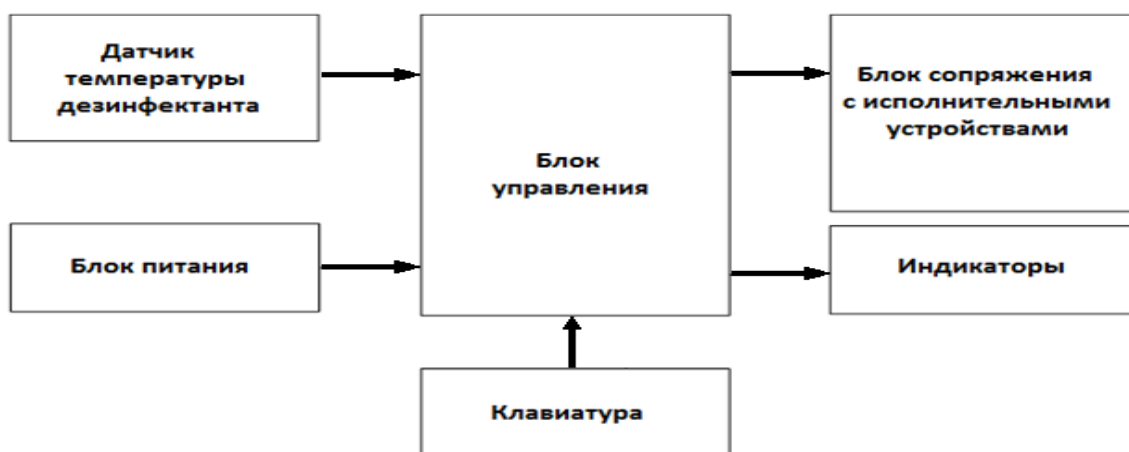
Рисунок 4.1 – Структура устройства управления моечной машиной для гибких эндоскопов.
